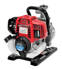
Honda WX10 е бензинова помпа с капацитет 130 литра сладка вода в минута, която изпомпва през 1-инчова тръба. Оборудвана е с 4-тактов OHV двигател Honda GX250, има налягане 3,6 bar и може да работи 80 мин. Предназначена е за отводняване, напояване и универсално почистване. Използва се широко за изпомпване при наводнения и с повдигане на всмукателна глава от 7 метра, често се използва за източване на наводнени изби, мазета или лодки.
